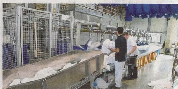
An der Sortierstation werden die einzelnen Teile für die Reinigung vorbereitet.
